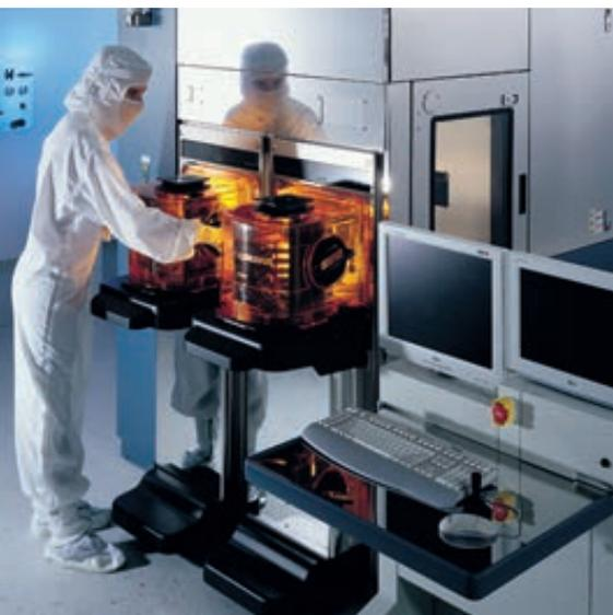
Machine d'inspection Wafer COMPASS Pro
