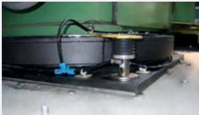
Vanne proportionnelle très robuste galvanisée par électrolyse. Grande précision de retour à l'équilibre, d'où la grande constance de niveau de  $\pm 1/10$  mm. **Convient pour les isolateurs pneumatiques Bilz FAEBI®, FAEBI®-HD et BiAir®.**
