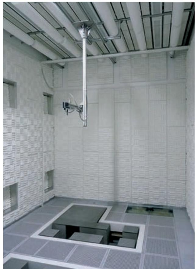
Salle d'expérimentation de 4,2 m de hauteur sous plafond et matériaux d'isolation acoustique (livrés et construits par Bilz)
