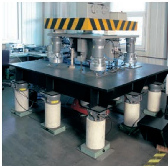
AIS™ sur banc de test Bilz
