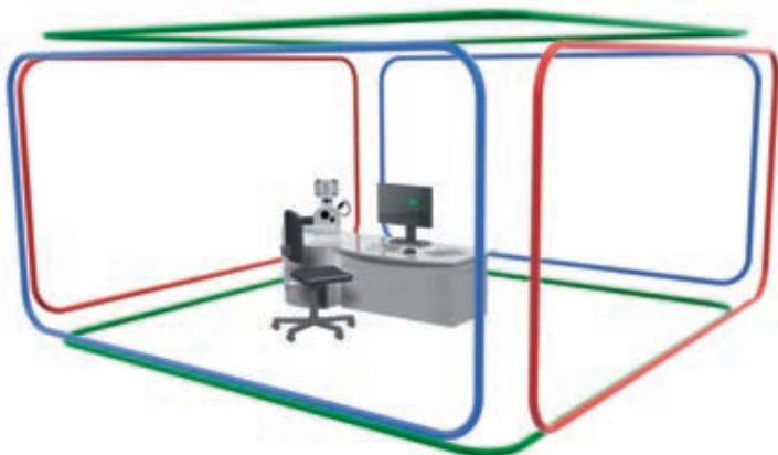
Bilz Magnetfeldkompensation durch Raumspulen
