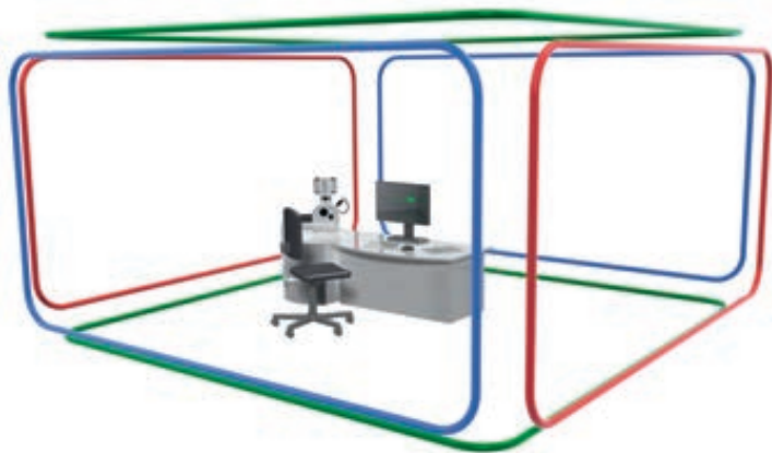
Compensation de champ magnétique Bilz par bobines de pièces
