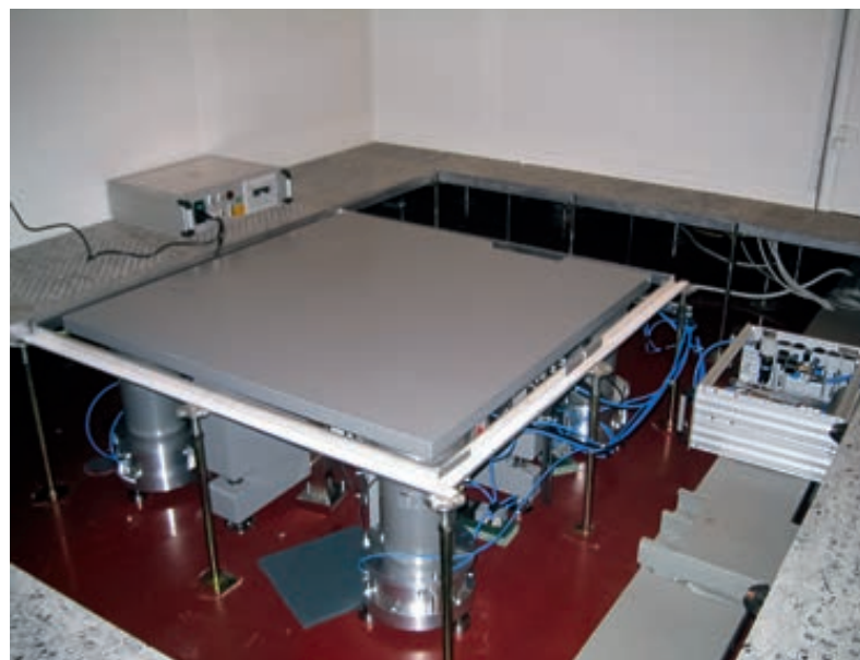
Plateforme pour intégration en faux plancher / salle blanche avec masse supplémentaire pour abaissement du centre de gravité
